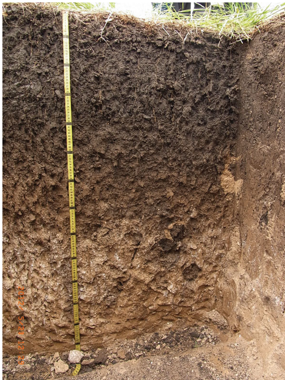
Рисунок 5.1. Типичный чернозем Бельцкой степи. Профиль почвы включает 70-80 см чернозема с зернистой структурой и обильными тонкими корнями; более 30-40 см, смешанный с норками дождевых червей и слепышей, с карбонатным псевдомицелием, также хорошо укоренившимся; на пористом желтовато-коричневом лессе.
